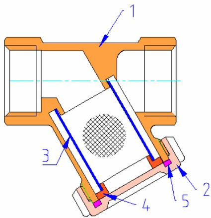
Фильтр состоит из корпуса 1, заглушки 2, фильтроэлемента 3, центрующей втулки 4 и прокладки 5. Корпус и заглушка выполнены из горячепрессованной, никелированной латуни марки CW617N. Центрующая втулка служит для фиксации фильтроэлемента в фильтровальной камере и
